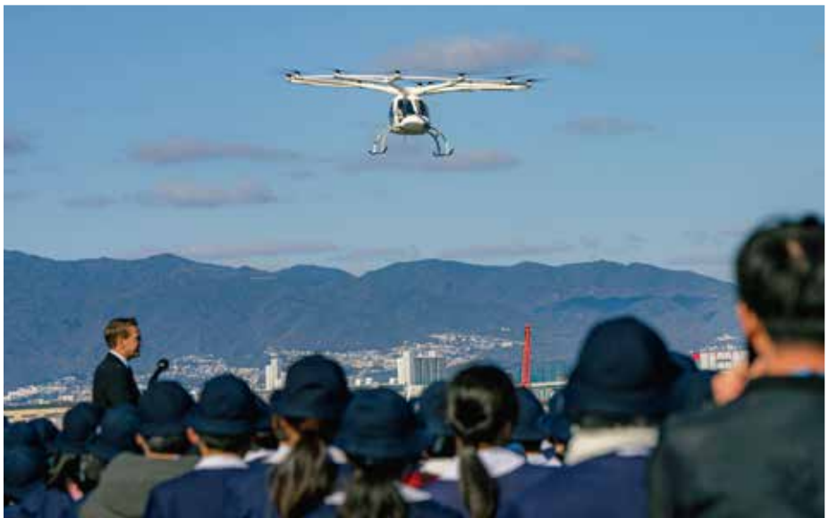
試験機は1人乗りの「ポロコプター 2X」(全長10m、高さ2.1m、重量約290kg) 電動モーターで18基のローターを回して飛び垂直離着陸機
